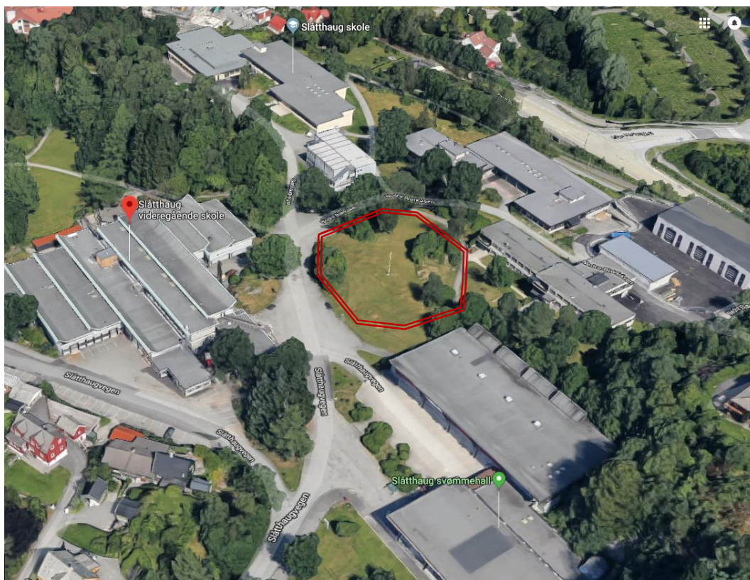
Figur 34 – Området (avmerket) vurdert som mest hensiktsmessig for sesonglageret/brønnpark. Resten av solvarmeanlegget, inkl solfangere og korttidslager vil ligge i nærheten. Unntaket er eksisterende sentral med gjenvinning av spillvarme, som ligger nede ved isbanen og vil da utnytte eksisterende rørstrekk. Arealer over bakken kan etter etablert brønnpark igjen benyttes til andre formål.
